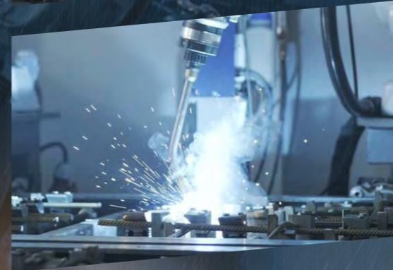
Технология сварки крестообразных соединений Сетки АТФ [Армокаркаса] при помощи роботизированной техники позволяет добиться стабильной прочности с усилием до разрушения до 60 кН (6 тс) каждого сварного шва, что обеспечивает надежность конструкции анкерной крепи и, соответственно, безопасность горно-проходческих работ.
