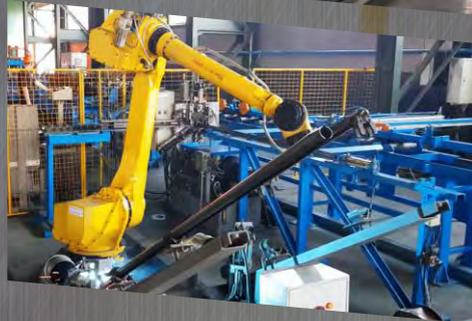
Точные настройки линии позволяют добиваться низких отклонений от заданных геометрических параметров фрикционного анкера, таких как его прямолинейность и диаметр по всей длине, что прямым образом влияет на технологичность его установки и самый важный показатель – несущую способность.
